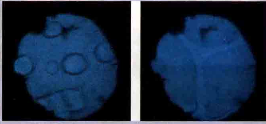
Elmas mengene hücresi mikroskop yardımıyla izlenmekte ve sıvı hidrojenin donması görülmektedir. Hücresinin çapı 200 mikrometredir. Her iki fotoğraf 54 kbar basınç altında çekilmiştir ve hidrojenin 60 °C'den oda sıcaklığına dereceli kristalleşmesini göstermektedir. Soldaki fotoğrafta kristaller yuvarlak tanecikler şeklinde oluşmuştur ve sağdakinde ise birleşerek büyük kristaller halinde hücre içini doldurmuştur. Sol üst kısımda görülen karaltı, basıncın ölçülmesi için hücreye yerleştirilen bir yakıt kristalidir.
