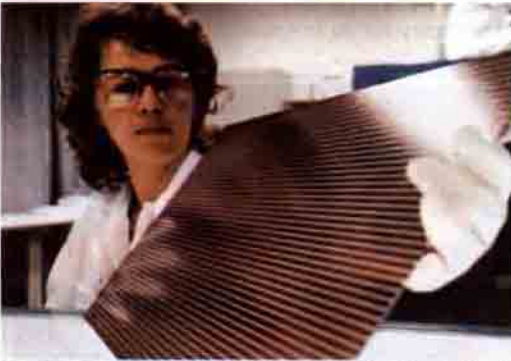
Bu pencere camı, küçük bir santraldir. Cama binde bir milimetre kalınlığındaki bir silisyum tabakası yapılmıştır. Bu kristal olmayan ince tabaka teknolojisinin verim oranı % 8'dir. Bununla birlikte, ileride %20 ye kadar yükseltilmesi planlanmaktadır.
