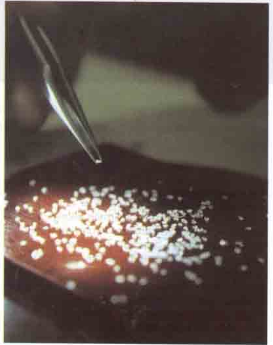
Titizlikle seçme: Kayayı bileşen minerallerine ufaldıktan sonra kristaller analiz için seçilir.
