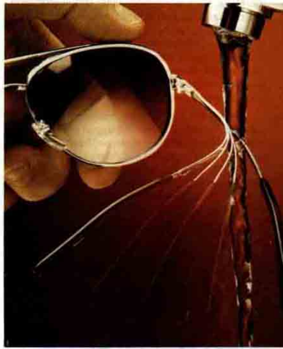
ŞBA gözlük çerçevesi 54°C sıcaklıktaki suya daldırılınca, anı olarak ilk şekline dönmektedir.
