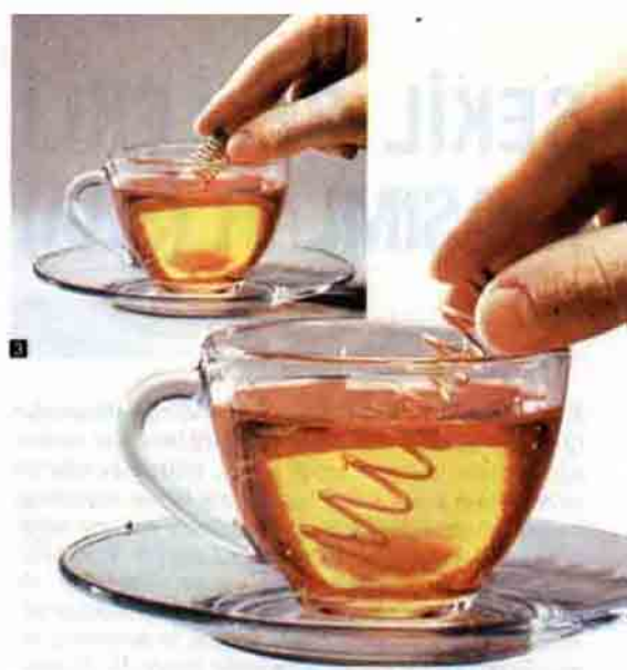
ŞBA bronz yay, sıcak sıvı içine daldırıldığında genişler.
