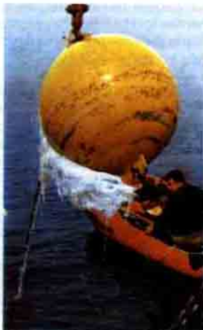
Akıntı ölçer sistemlerin kayıt sonlarında denizden çıkarılışı ve geriye alınışı.
