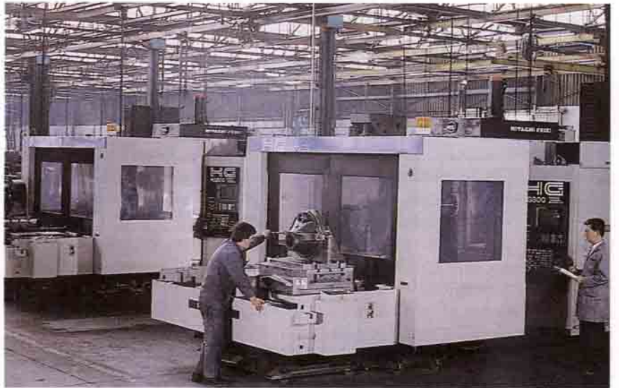
Fabrikada incelikli iş isteyen parçalar, bilgisayar kontrollü talaşlı imalat makinesinde gerçekleştiriliyor
