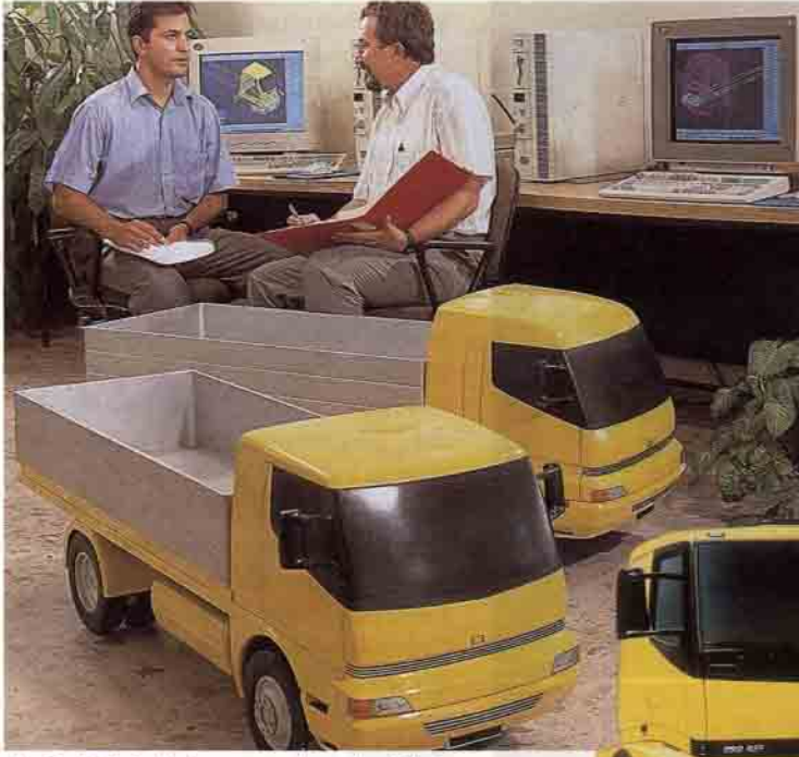
Ar-Ge biriminde tasarım çalışmaları bilgisayar destekli yapıyor. Çizimi yapılan model üzerinde, üç boyutlu görüntü sunarak mühendislik çalışmalarının yapılmasına olanak sağlayan bu bilgisayar programlarıyla resimde görülen Profesyonel isimli kamyon serisi tasarlanmıştır.
