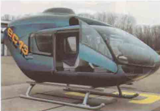
EC 135 Eurocopter'in ikibin, üçbin adet olarak tahmin edilen küçük helikopter pazarı için geliştirdiği yataksız ana rotor, Fenestron kuyruk rotorlu, dördüncü nesil helikopteri EC 135'in bazı parçalarının ülkemizde TAI'de üretilmesi sözkonusu.
