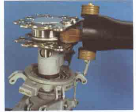
EC-135 yataksız-mafsalsız rotor palı, döner tabla rotor tacı bağlantı mekanizması
