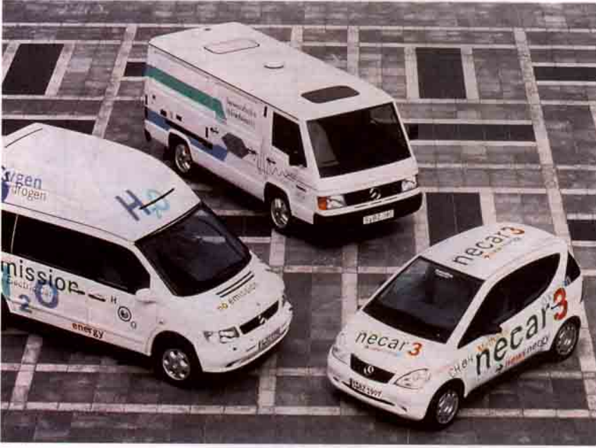
Daimler-Benz'in ürettiği üç kuşak Necar birarada. Necar I ve Necar II yakıt olarak doğrudan hidrojeni kullanıyorlardı. Yakıt deposunun ve öteki aygıtların büyüklüğü nedeniyle bu taşıtlar minibüs tipindeydi. Ancak Necar III'te yakıt olarak metanolün kullanılması yakıt deposunu çok küçülttü. Donanımın geri kalanındaki küçülme sonucunda da günümüz otomobillerinden hiçbir farkı olmayan bir elektrikli otomobil ortaya çıktı.
