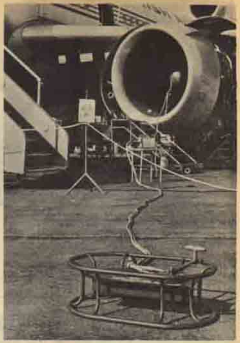
Şekil — 2 Uçak motoru türbin pervanelerinin İridium-192 radyoizotopu ile radyografik muayenesi.
