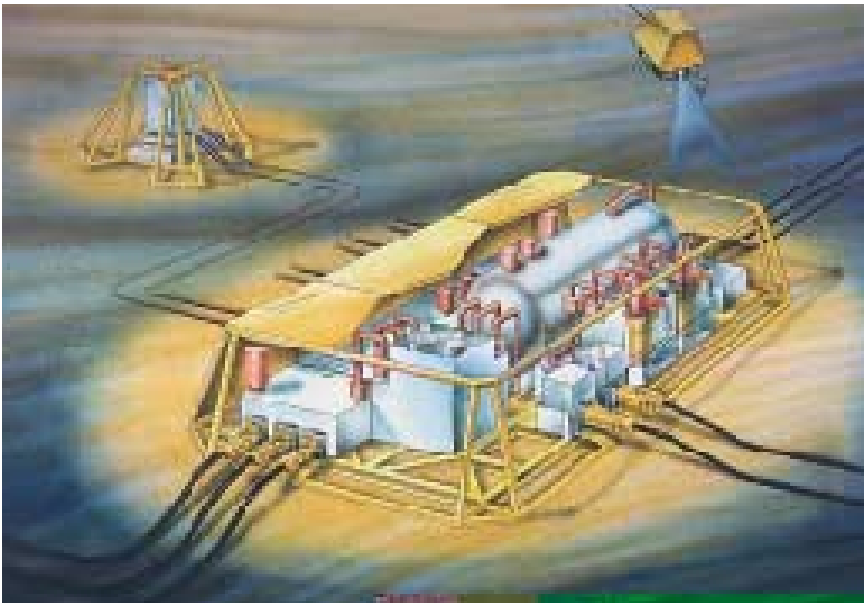
Deniz tabanındaki petrol fabrikası. Norveçli bir firmanın projesi olan Subsis adlı bu yapının petrol platformlarından hiçbir farkı yok, fakat suyun altında olduğu için görünmüyor.
