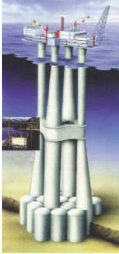
Deniz tabanına kendi ağırlığıyla oturan beton ağırlık platformu. Bu yapıların hem boyutları, hem de taşıdığı yükler çok büyüktür. Çoğu zaman rafineri olarak da kullanılmak üzere tasarlanırlar.
