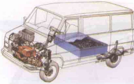
Peugeot ve Citroen'in J5 ile C15 furgonetleri, iki yıldan beri elektrikli olarak da yapılmaktadır. Motor, fiyatını ucuz tutmak için aynen klâsik bir termik motorun yerine takılabilecek biçimde tasarlanmıştır (soldaki çizime bakınız).
