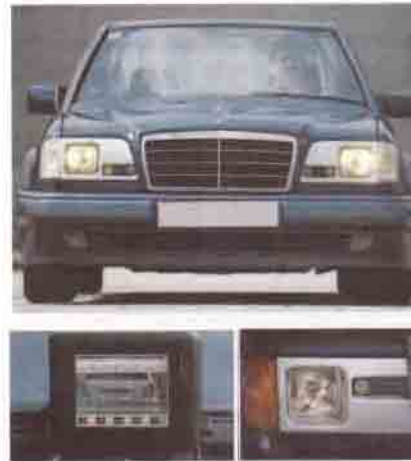
Ön lambaların yanındaki deliklere yerleştirilen kızılötesi sensörler, öndeki araçla aradaki mesafeyi ölçüyor.
