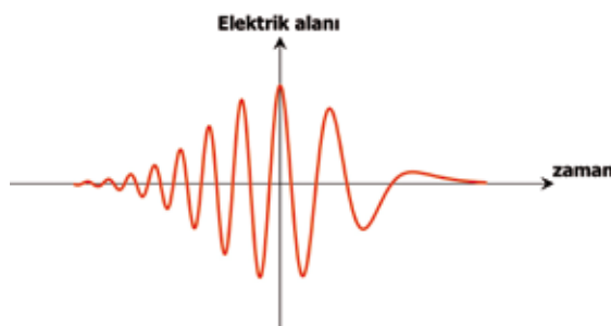
Şekil 8: Dağılımı değeri eksi olan bir ortamda ilerlerken değişime uğrayan optik darbenin elektrik alan dağılımı
