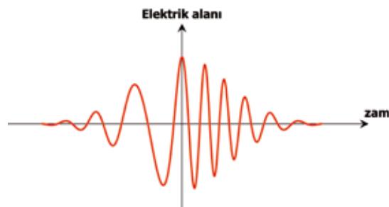
Şekil 7: Kerr ortamında ilerlerken, kendi başına faz kiplemesi sonucunda değişime uğrayan optik darbenin elektrik alan dağılımı
