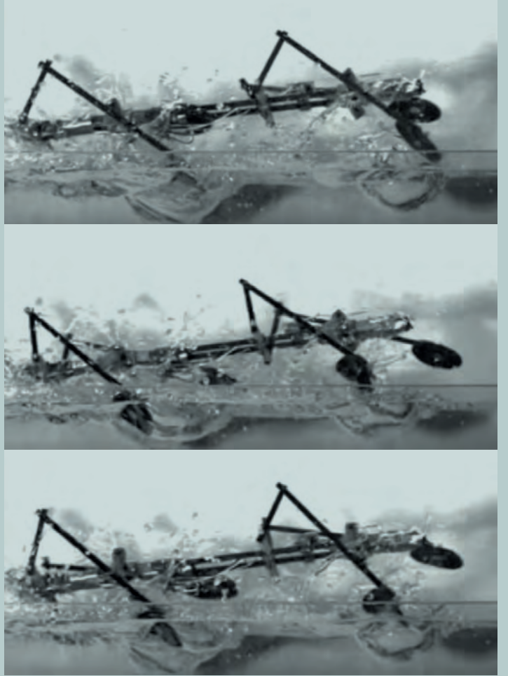
Dünyanın ilk su yüzeyinde yürüyen robotu da Prof. Dr. Sitti ve ekibinin çalışmalarının sonucu. Göllerde suyun üstünde yürüyen böceklerin ayaklarında bulunan su itici tüyleri incelediklerinde yüzey geriliminin böceklerin su üstünde kalmasını sağladığını görmüşler.
