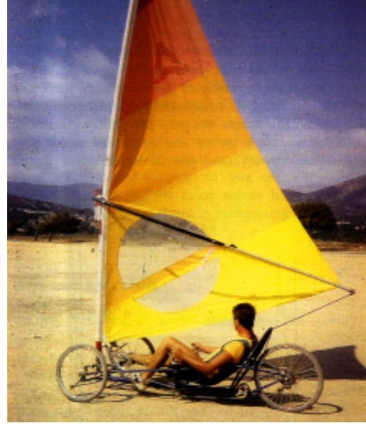
Şekil 10: Üç bisiklet tekerleği üstünde bir kara yelkenlisi. Öndeki ikisi yön vermede kullanılıyor ve yelken bir rüzgâr sörfü yelkeni.
