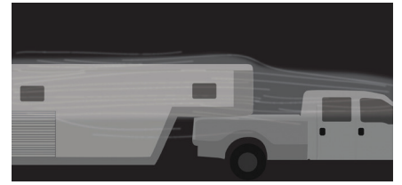
Şekil 4. Kamyonetin etrafındaki hava akışının dumanla görüntülenmesi
