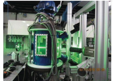
Şekil 10. Dört kameralı ayrıışık parçacık hızı görüntüleme düzeneği
