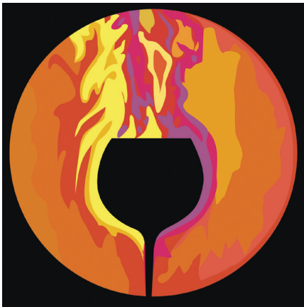
Şekil 12. Sıcak su dolu kadehin renkli iz fotoğrafı yöntemi ile elde edilen görüntüsü
