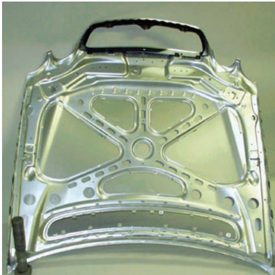
Alüminyumun üstün şekil alma kapasitesi sayesinde alüminyum levhadan tek işlemlerde preslenmiş ön ızgaralı kaporta
