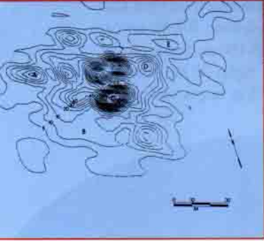
16. yy'ye ait olduğu sanılan bir batığın manyetometre taramasıyla elde edilmiş eş-manyetik çizgilerden oluşan bilgisayar destekli manyetik haritası
