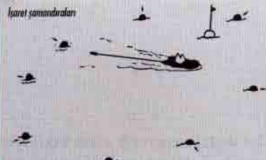
Ok yönünde odaklanan hatlar boyunca dıştan içe doğru radyal tarama yapılır
