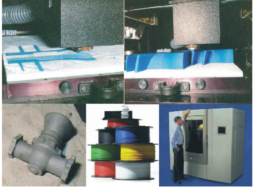
Eritip tortulandırarak modelleme (FDM) makinesinin kullandığı polimer iplik bobinleri, ve makinenin çalışma sırasındaki durumu. Bu sistem kullanılarak yapılmış bir jet itki sistem vanası (sol altta)
