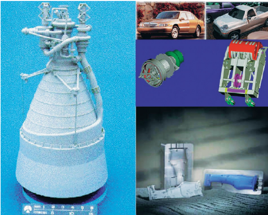
Seçici lazer sinterleme yöntemi kullanılarak yapılan bir jet motor parçası. Sağ altta, bu yöntemle yapılmış bir kalıp. SFF yöntemiyle üretilmiş çeşitli cihazlar. Sağ üst köşede gerçek boyutunun dört kat daha büyük olan yarı-saydam bir model.
