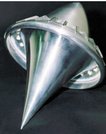
Minyatür bir hafif uzay aracı, 10 kilowattlık bir lazer enerjisiyle 30 m yükseğe çıkarılabiliyor. Daha büyük tasarımlar, araca yörüngeye oturabilecek kadar büyük bir hız sağlayabilecek.
