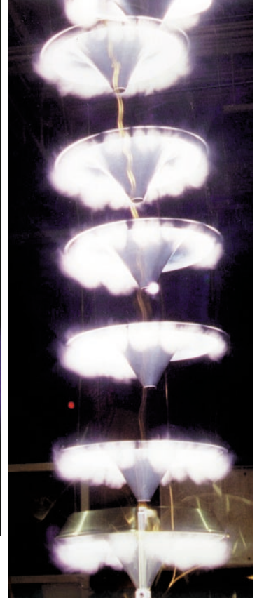
Minyatür bir hafif uzay aracı, 10 kilowattlık bir lazer enerjisiyle 30 m yükseğe çıkarılabiliyor. Daha büyük tasarımlar, araca yörüngeye oturabilecek kadar büyük bir hız sağlayabilecek.
