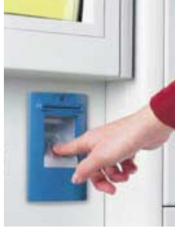
Şifre girilerek ya da manyetik bir kart okutarak açılan kilitlerde sorun kartın kaybedilmesi ya da şifrenin unutulmasıydı. Parmak izine duyarlı kilitlerle bu sorunlar aşıldı.
