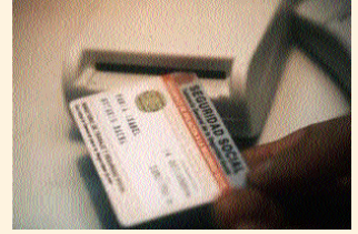
Akıllı kart okuyucuları, akıllı kartın içinde bulunan yongayla iletişime geçer.
