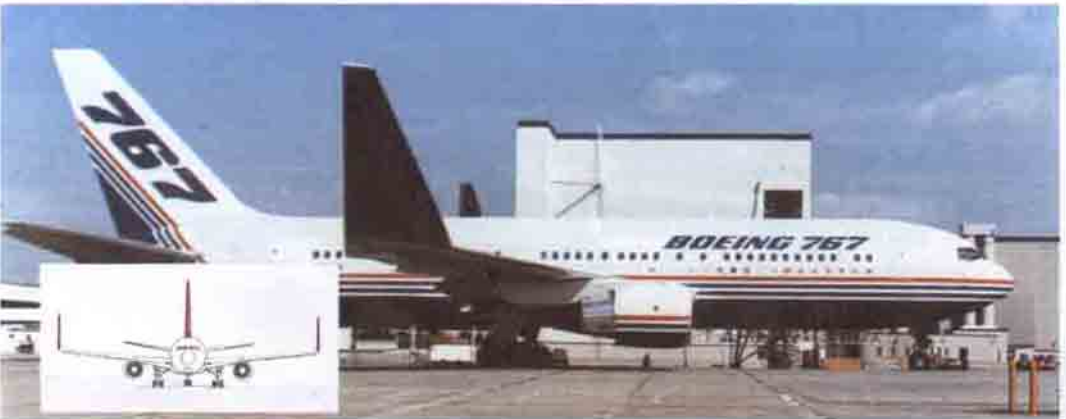
Bu günkü dar hava alanları için ekstra uzun kanatlara ihtiyacı olan (kanatların açıklığı 60 metrenin üzerinde) Boeing 767-X modelini, büyük zorluklar bekliyor. Çözüm: Yukarı açılıp kapanabilen kanat uçları (resimdeki kırmızı kısım). Katlanabilir kanatlar, uçak gemilerindeki jet-savaş uçaklarında denenmesine rağmen, sivil havacılıkta henüz rağbet görmedi.
