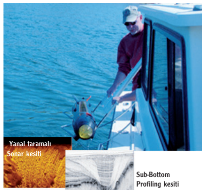
Şekil 4. Yanal taramalı sonar ve sub bottom profiling cihazını bir arada barındıran sistem
