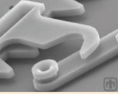
Birçok mikromekanik sistemde kullanılan mikrokilitlerden biri. Bu kilitler mekanik sistemlerin çalışmalarını kontrol etmek için kullanılır.
