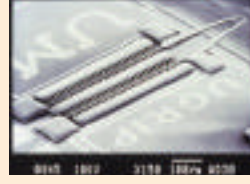
Deneysel amaçlı yapılmış bir "mikrocımbız". Tarak biçimindeki bölgeye elektrik akımı verildiğinde, tarağın dişleri elektrostatik olarak birbirlerini çeker ve cımbızın ucu kapanır.
