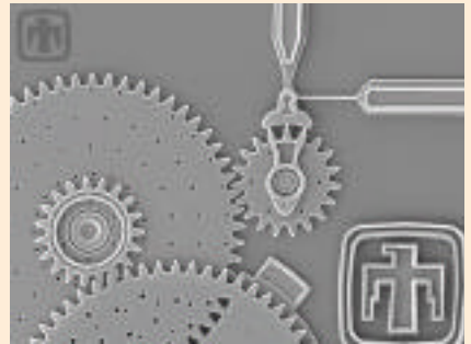
Büyük bir dişliyi sürmek için kullanılan sistem (solda). Küçük dişli, birbirine dik iki kol tarafından döndürülür. Kollara itki elektrostatik olarak verilir. Sandia Araştırma Merkezi'nce, yalnızca tek yönde dönmesi için geliştirilmiş bir mikromotor (ortada). İletişim alanında kullanılması düşünülmüyor. Sağdaki resimde, sağ üst köşede bulunan kollar, küçük dişliyi döndürür. Hareket, büyük dişilerce mekanik devrenin geri kalan bölümlerine aktarılır. Kollarn yarattığı kuvvet çok azdır ama dişli sistemi bunu yükseltir.
