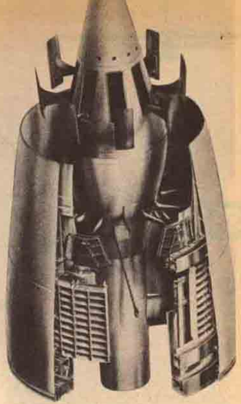
Mercure uçağı için SNECMA firmasınınca yapılan az sesli motör. Susturucu tertibat, kalkış ve inişte kullanılır. Uçuşta içeri çekilir. Motörün burnundaki bir tertibat, ses dalgalarını parçalıyor.
