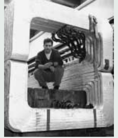
DONUT deneyinde kullanılan aygıt ve sözcü Lundberg (solda). Yüklü parçacıklar temizleyerek yüksüz nötrino demetini oluşturan mıknatıs (sağda)
