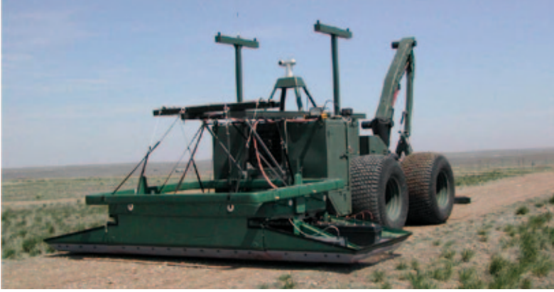
GPR teknolojisi (GPR, Ground Penetrating Radar) tekniğine dayalı uzaktan kumandalı arazi tarama aracı.
