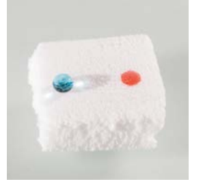
Su damlası (mavi) nanoselüloz süngerin yüzeyinde kalırken, yağ damlası (kırmızı) emiliyor.
