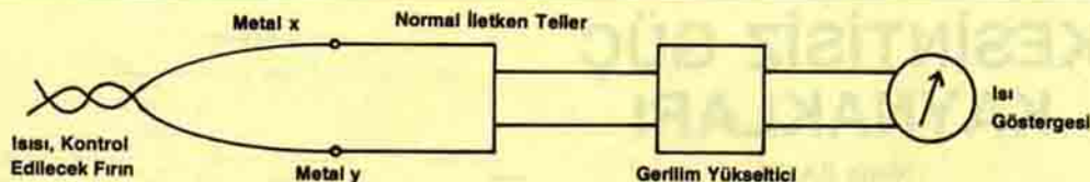
Şekil D : Termokapıl ile Isı Ölçme.
