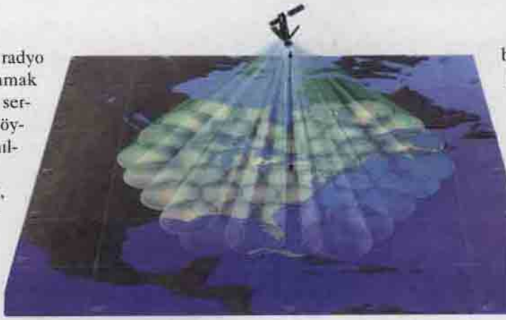
Iridium'un spot huzmeleri her biri 150 km çapındaki alanları kapsar. Cep telefonundan gönderilen sinyaller zayıf, bu yüzden uydunun gönderilen spot ışınlarının dar olması gerekir.
