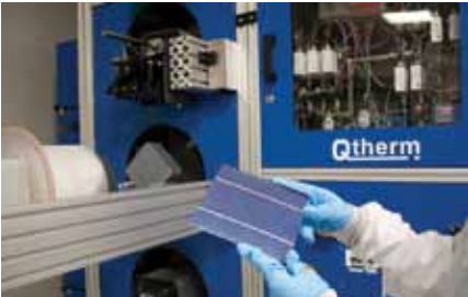
GÜNAM laboratuvarlarında üretilen bir kristal Si güneş gözesi
