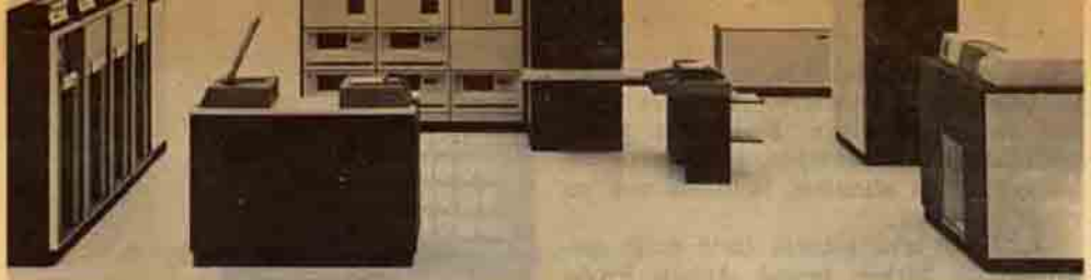
Yukarıda I.B.F. Sistem 370'in. Teyp, Disk, Merkez Proses ve Kontrol Üniteleri ile birlikte oluşan, sistem yapısı görülmektedir.
