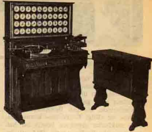
Yukarıda Herman Hollerith'in elektrikli kaydetme makinesi görülmektedir.
