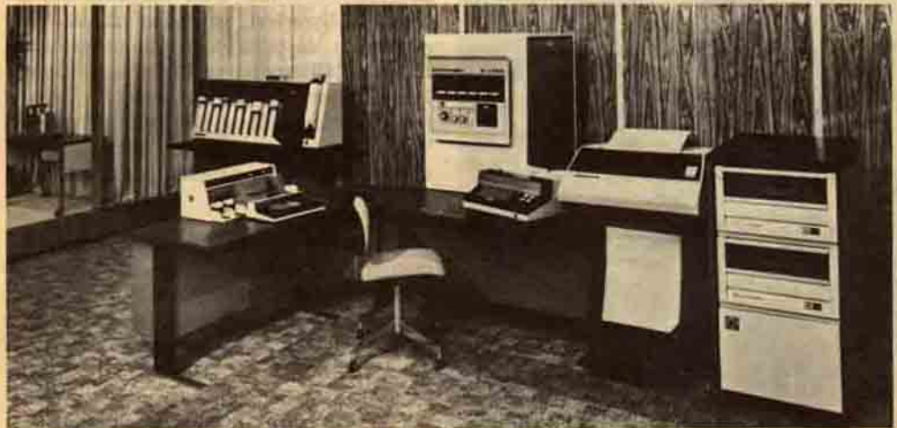
Yukarıda Burroughs B - 1714 sisteminin 1) Kart okuyucu ve delicisi, 2) Disk birimleri, 3) Satır yazıcı birimi ve 4) Merkez işlem biriminden meydana gelen yapısı görülmektedir.
