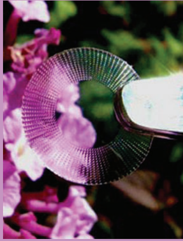
Net görmek: Stanford Üniversitesi'ndeki araştırmacılar tarafından geliştirilen bu hidrojel tabanlı yapay kornea fotolitografi kullanılarak desenlenmiş mikroskobik boşluklar içermektedir. Hastaya bir kez nakledildiğinde, hücreler boşluklardan ilerlerler ve yapay korneanın çevreleyen dokuya birleşmesine yardım ederler.
