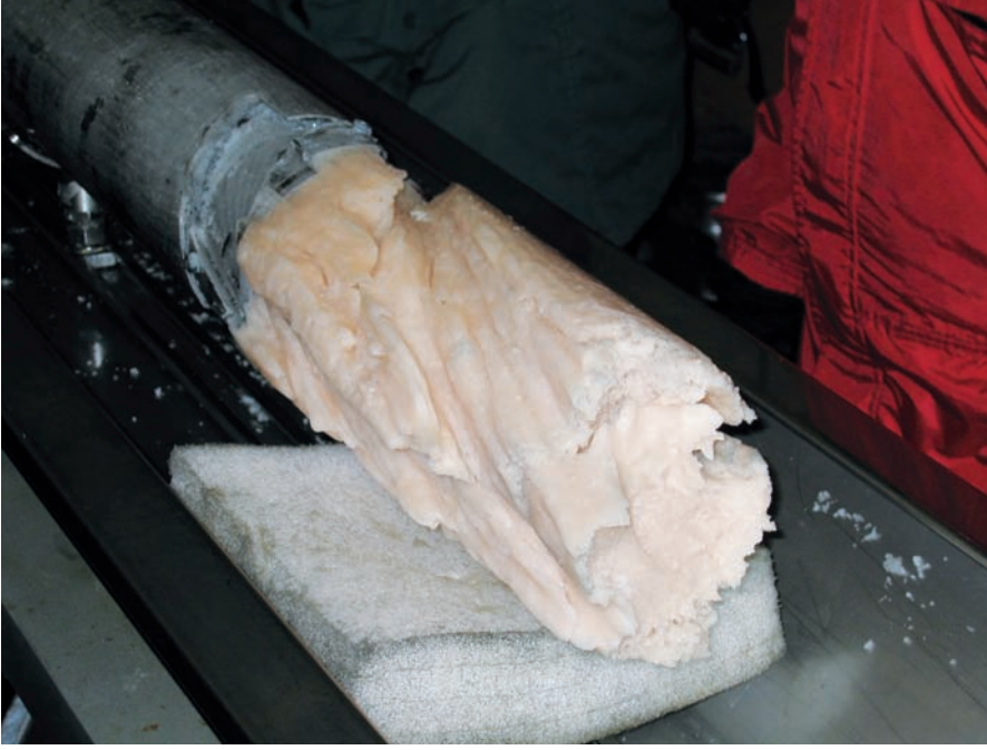
Buz çekirdeğinden çıkarılan örneğin açık pembemsi rengi buzun buzulaltı suyundan oluştuğunun bir göstergesi.
