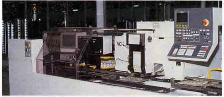
Devrelerin kontrol edildiği otomatik On-line makinesi bilgi ağına kendiliğinden veri aktarıyor.
