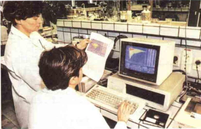
Polis laboratuvarında sıvı kromatografi ile UV kullanılarak patlayıcı maddenin ne olduğu anlaşılabilir.
