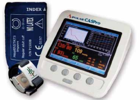
Sol alt köşede bileğe takılan sensör yer alıyor. Sağ köşede ise bilekteki sensörden gelen verileri işleyen ve CASP değerini hesaplayan ekranlı cihaz yer alıyor. ( www.healthstats.com/en/pulse-caspro-system.html )
