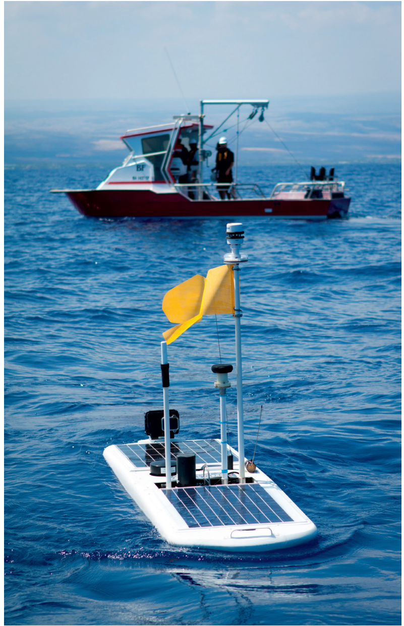
Hareket gücünü doğrudan dalgalardan alan WaveGlider® adlı yeni nesil bir dalga planörü, 2011 yılının Kasım ayında San Francisco'dan yola çıktıktan yaklaşık bir yıl sonra Avustralya sahillerine ulaşarak yeni bir dünya rekoru kırdı. Resimde dalga planörünün su üstündeki ana gövdesi görülmüyor.
