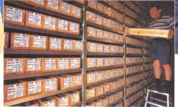
Karotlar numaralanır; fotoğrafları çekilip, ait oldukları derinliğe göre sıralandıktan sonra, daha sonraki araştırmalar için merkez depolara yerleştirilir.
