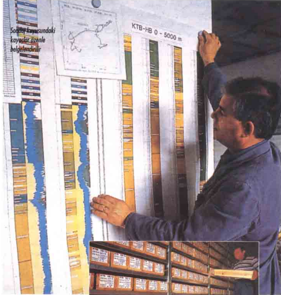
Karotlar numaralanır; fotoğrafları çekilip, ait oldukları derinliğe göre sıralandıktan sonra, daha sonraki araştırmalar için merkez depolara yerleştirilir.
